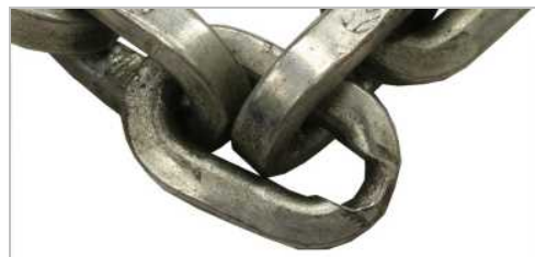
Duży stopień zużycia ogniwa łańcucha.
